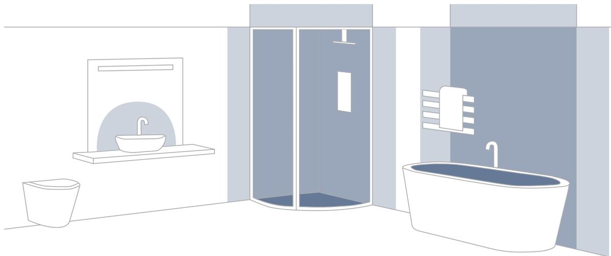
Bei der Montage von Waves im Badezimmer muss berücksichtigt werden, dass das Badezimmer in 4 Zonen [0-3] unterteilt ist. Aufgrund der IP-Klasse kann das Gerät in Zone 2 oder 3 platziert werden.
